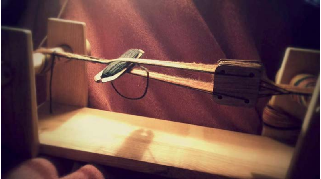
Figura 1. Elaboración de cenefa de lana tejida en telar de tablillas. Realizada por Laura Jiménez con telar islandés del siglo x (réplica). Tablillas cuadradas de madera de haya (réplica). Fotografía: Laura Jiménez (2016).
